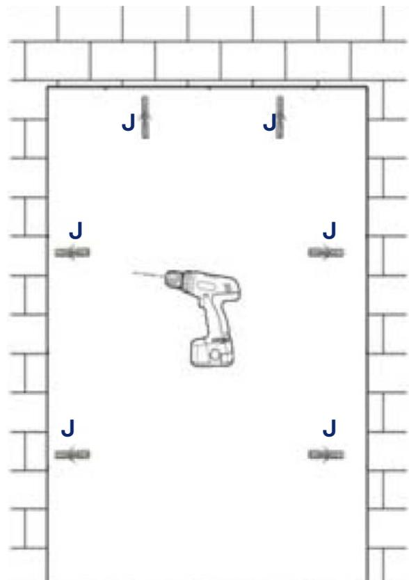
4. Installer la moustiquaire et régler les vis d'expansion avec la clé Allen (ou une clé Allen que vous avez). Placer les vis de fixation du cadre et mettez les caches de vis par dessus (H).
