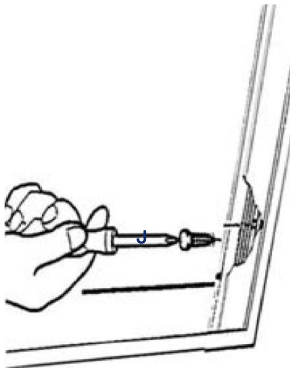
5. Insérez le ressort dans la charnière supérieur. Fermez-le avec le bouchon Allen. Vous pouvez augmenter la force du ressort en tournant le bouchon dans le sens horaire avec la clé Allen. Placer la broche.
